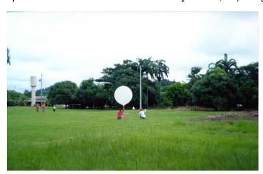
medida dos ventos em altitude por radar usam-se balões piloto maiores (100 g) ou balões sonda cujas dimensões variam segundo o peso e a resistência do equipamento transportado (1 a 2 kg) até altitudes de 30 km cuja velocidade ascensional deve ser suficiente para assegurar a ventilação necessária aos elementos sensíveis.
